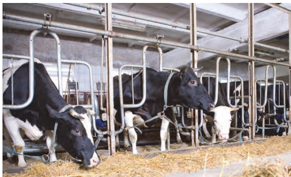
Рис. 2.3 Стойловое оборудование ОСК-25М
